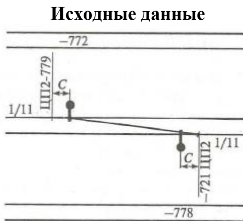
Рис 1. Схемы фиксации одиночных воздушных стрелок
