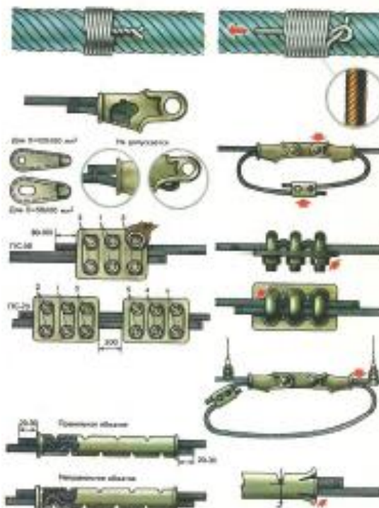
Рис 1.2. Виды стыкования проводов воздушных линий
