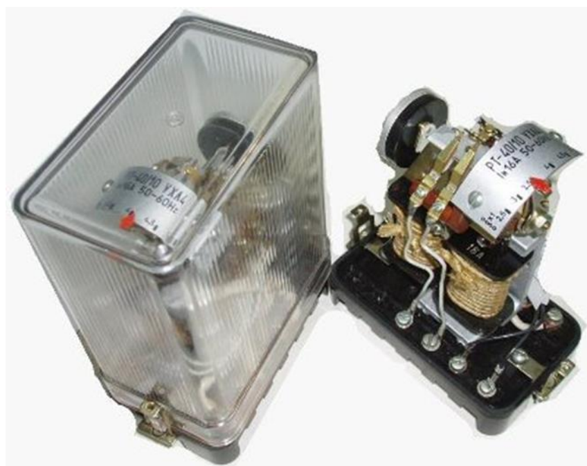
Рис. 7.2. Токовое реле серии РТ-40: a — общий вид; б и в — схемы последовательного и параллельного соединения катушек
