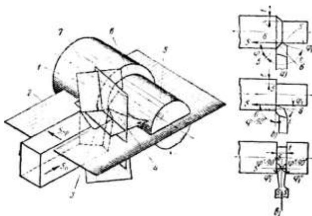
Углы резца. Для определения углов резца стандартом установлены следующие понятия: плоскость резания, (основная плоскость и главная секущая плоскость. Для удобства определения некоторых углов режущего клина целесообразно ввести дополнительное понятие — нормальная плоскость.
