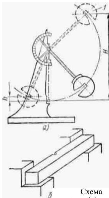
Схема маятничкового копра (а) и установка образца на опорах копра (б)
