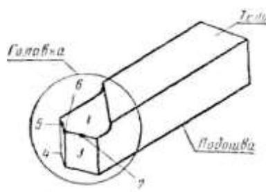
опорной поверхности подошвы, на которую опирается резец при установке на станке, и тела (стержня), с помощью которого резец закрепляется в резцедержателе.
