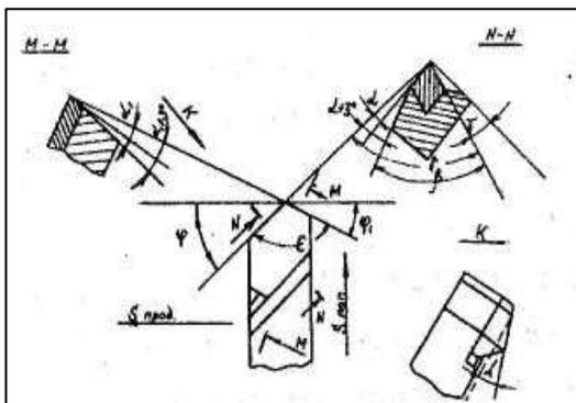
Главным передним углом  $\gamma$  называется угол, заключенный между следом плоскости касательной к передней поверхности, и следом плоскости, проведенной через главную режущую кромку перпендикулярно к плоскости резания.
