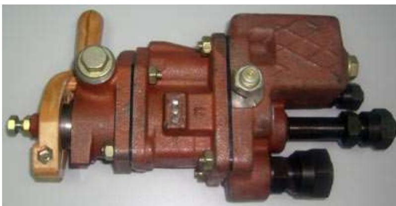
*Рис. 8.2 Общий вид крана вспомогательного тормоза локомотива №254*
