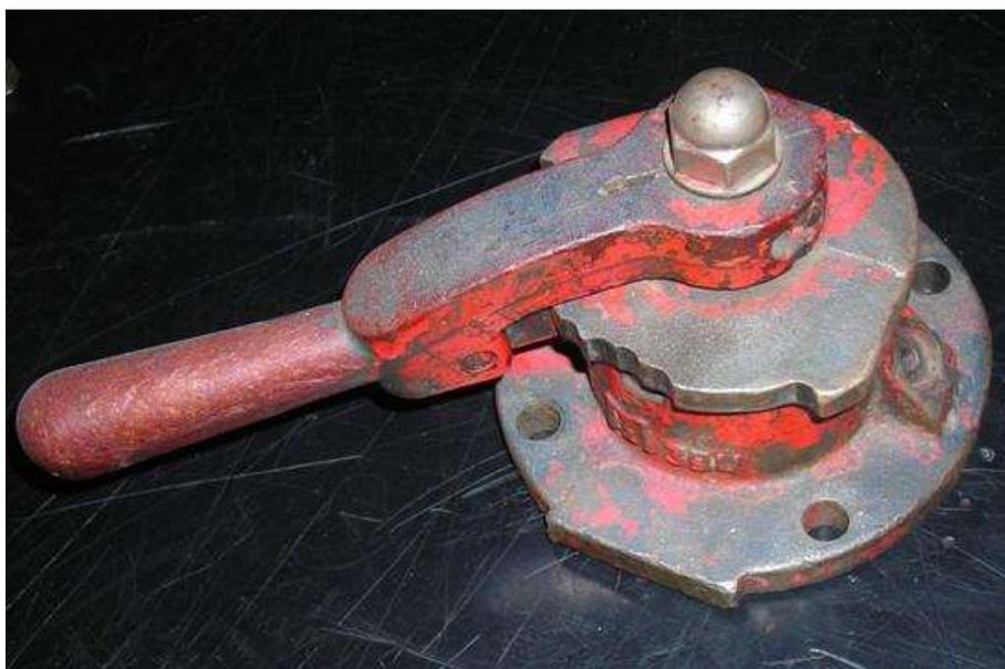
*Рис. 7.7 Фрагмент (фото) крана машиниста*
