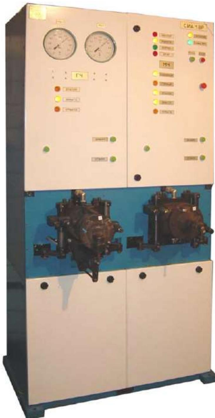
*Рис. 23.2 Стенд для проверки после ремонтных работ магистральных и главных частей грузовых воздухораспределителей 483, 483М, 483М-01, 483А и 483А-01*
