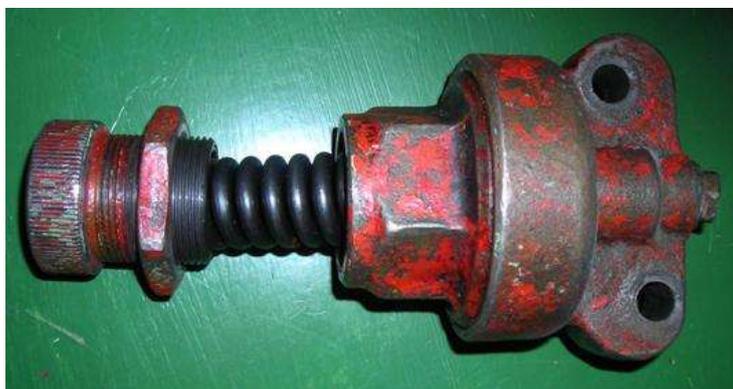
*Рис. 7.4 Редуктор - частично разобран (вывернут регулировочный стакан)*
