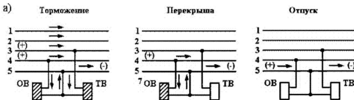
Рис. 14.1 Пятипроводные схемы ЭПТ
