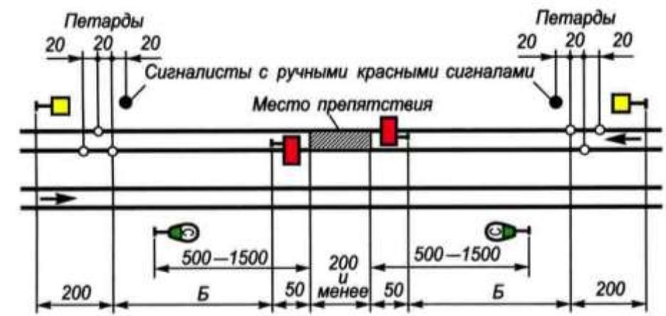
**Рис.20.2** Схема ограждения места препятствия фронтом работ менее 200 м на одном из путей двухпутного участка
