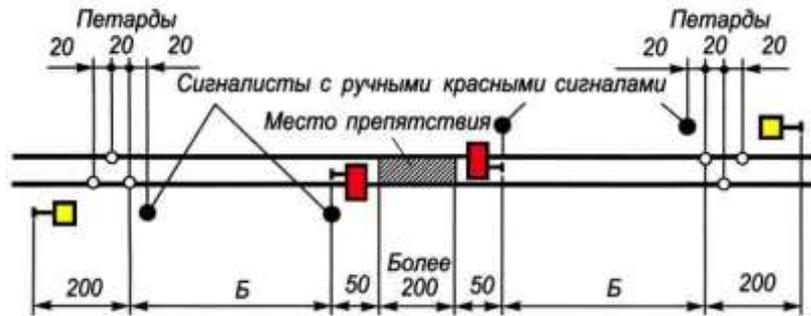
**Рис.20.4** Схема ограждения места препятствия фронтом работ более 200м на однопутном участке
