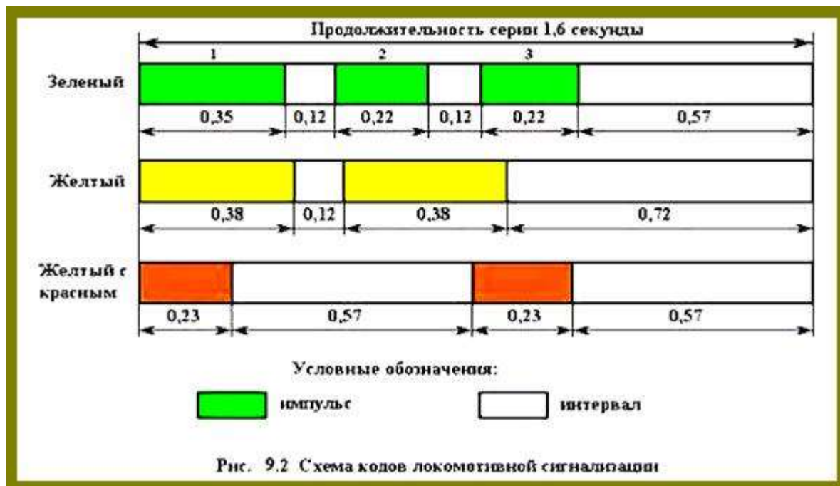
Рис. 1.2 Схема кодов локомотивной сигнализации
