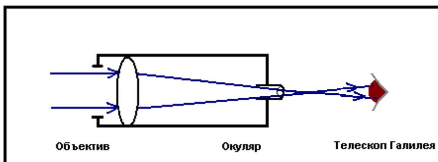
**Рефрактор (refracto–преломляю)** - используется преломление света в линзе (преломляющий). “Зрительная труба” сделана в Голландии [Х. Липперсгей]. По приблизительному описанию ее изготовил в 1609г Галилео Галилей и впервые направил в ноябре 1609г на небо, а в январе 1610г открыл 4 спутника Юпитера.
