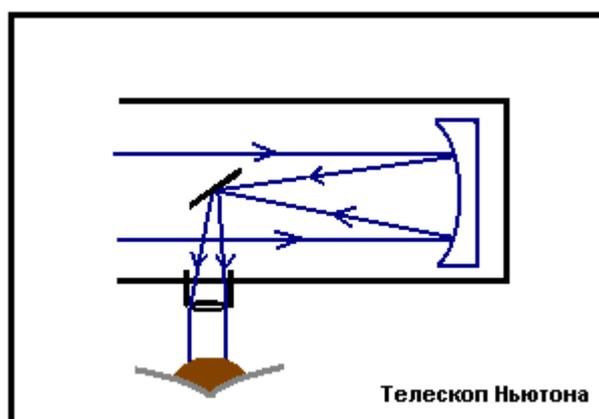
**Рефлектор (reflecto–отражаю)**- используется вогнутое зеркало, фокусирующее лучи. В 1667г первый зеркальный телескоп изобрел И. Ньютон (1643-1727, Англия) диаметр зеркала 2,5см при 41х увеличении. В те времена зеркала делались из сплавов металла, быстро тускнели.
