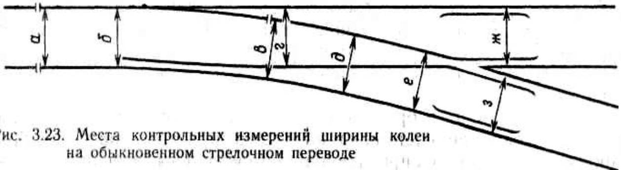
Рис. 3.23. Места контрольных измерений ширины колеи на обыкновенном стрелочном переводе
