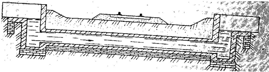
Земляное полотно предназначено для укладки верхнего строения пути, восприятия нагрузок от подвижного состава, передаваемых через элементы верхнего строения пути и для обеспечения устойчивости железнодорожного пути.
