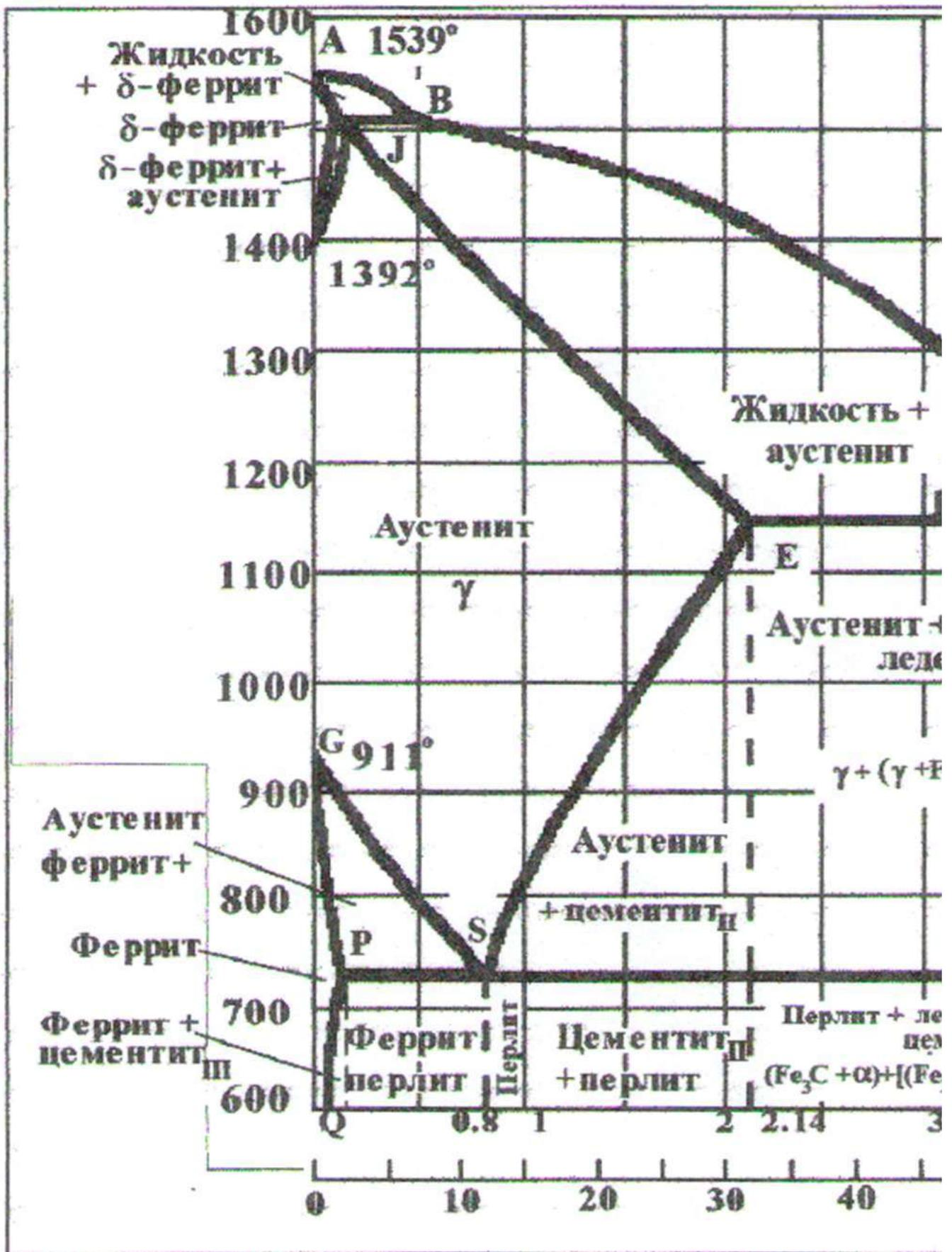
Рис. 1. Диаграмма железо-цементит (Fe-Fe<sub>3</sub>C)
