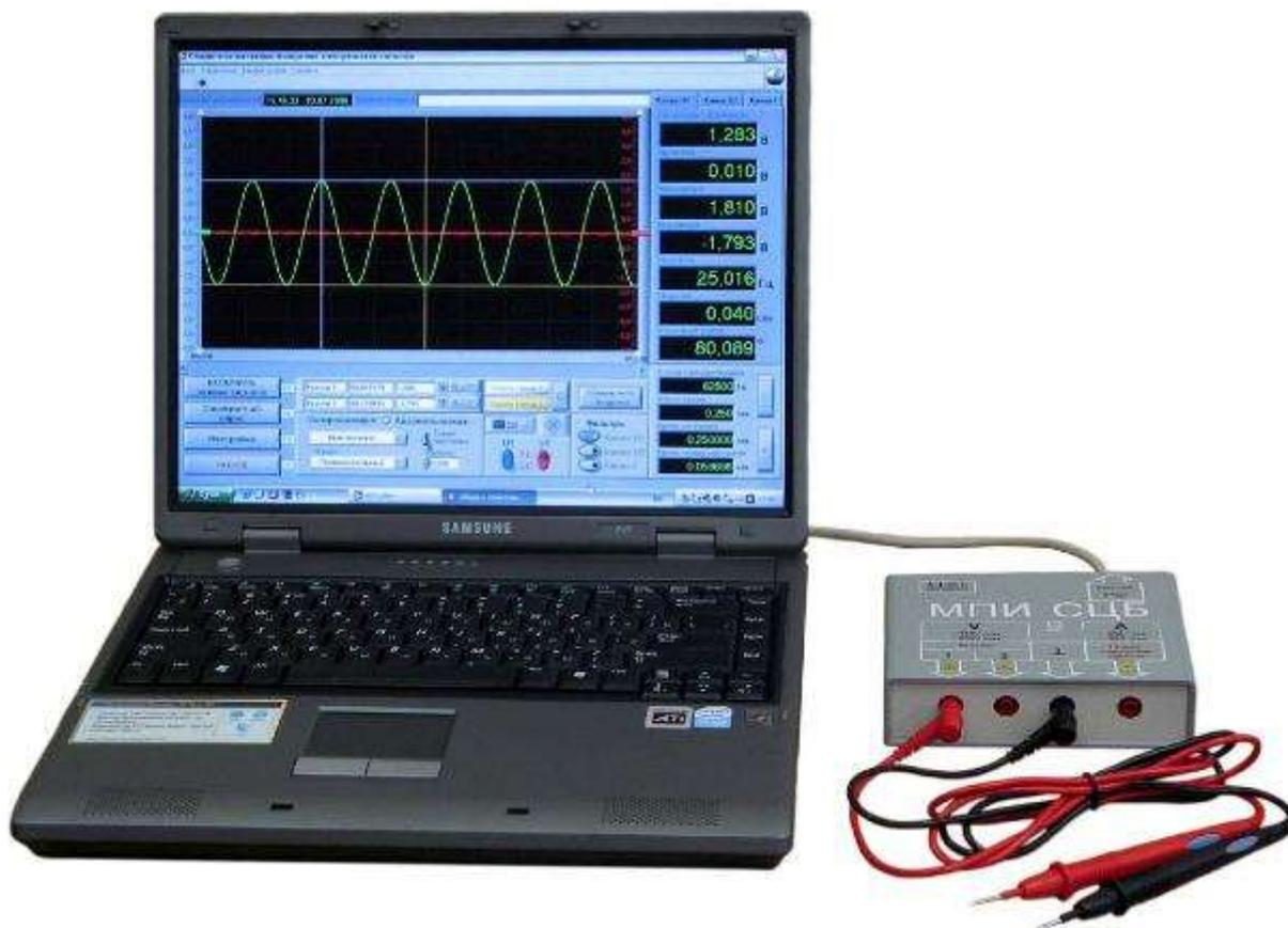
Многофункциональный переносной прибор *МПИ-СЦБ* инженера *СЦБ* предназначен для измерения, отображения и регистрации следующих сигналов:
