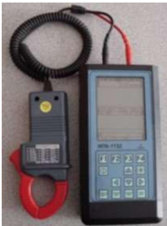
Прибор *ИПК-1132* предназначен для: измерения параметров кодовых сигналов *АЛСН*; визуального отображения формы кодовых посылок тока *АЛСН* и огибающей кодового тока; определения параметров кодов *АЛСН*; записи измеренных параметров в память прибора с последующим просмотром.
