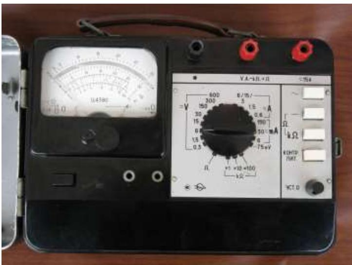
Приборы магнитоэлектрической системы с полупроводниковыми выпрямителями Ц4380 (в эксплуатации такие приборы имеются в большом количестве, а регулировочные таблицы РЦ составлены в соответствии с параметрами этих приборов) реагируют на средневыпрямленное значение переменного напряжения или тока.
