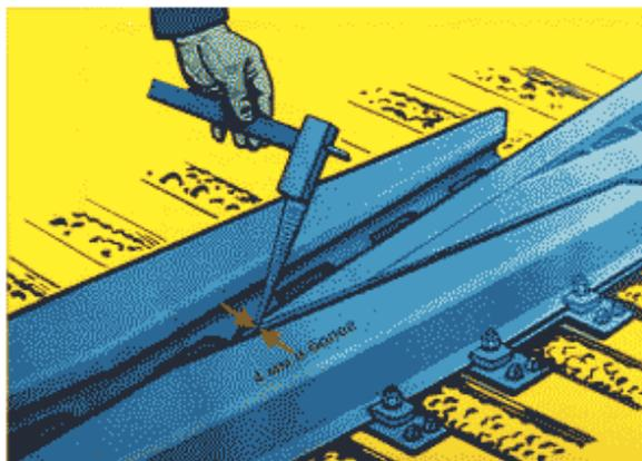
*Рисунок 3 Отставание остряка от рамного рельса подвижного сердечника крестовины от усовика на 4мм и более.*
