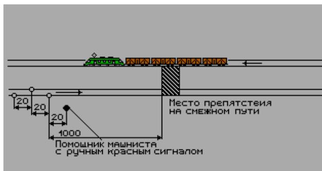
**Рис. 37 Ограждение остальных поездов при вынужденной остановке на перегоне.**
