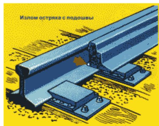
**Рисунок 7 Излом остряка или рамного рельса.**
