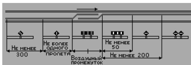
При обращении 12-вагонных электропоездов расстояние от воздушного промежутка до постоянного знака "Поднять токоприемник" должно быть не менее 250 м.
