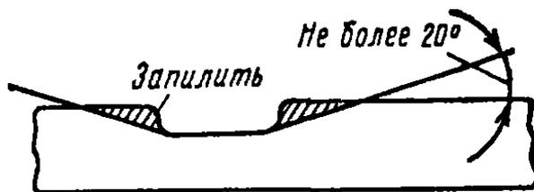
Рисунок 18.2. Запиловка выемки в угольной вставке полоза токоприемника
