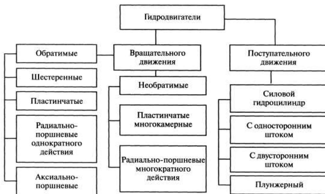
Гидроцилиндры являются простейшими гидродвигателями, выходное звено которых совершает возвратно-поступательное движение, причем подвижным звеном могут быть как шток так и корпус цилиндра.
