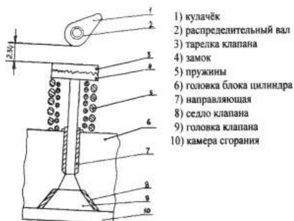
Схема регулировки клапанов
