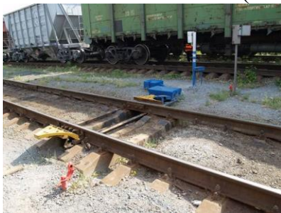
Рисунок 3 - Положение «Упор снят»
