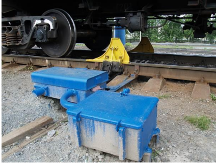
Рисунок 2 - Положение «Упор установлен».
