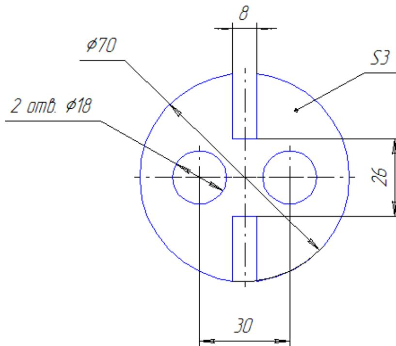
Проставление обозначения толщины детали.
