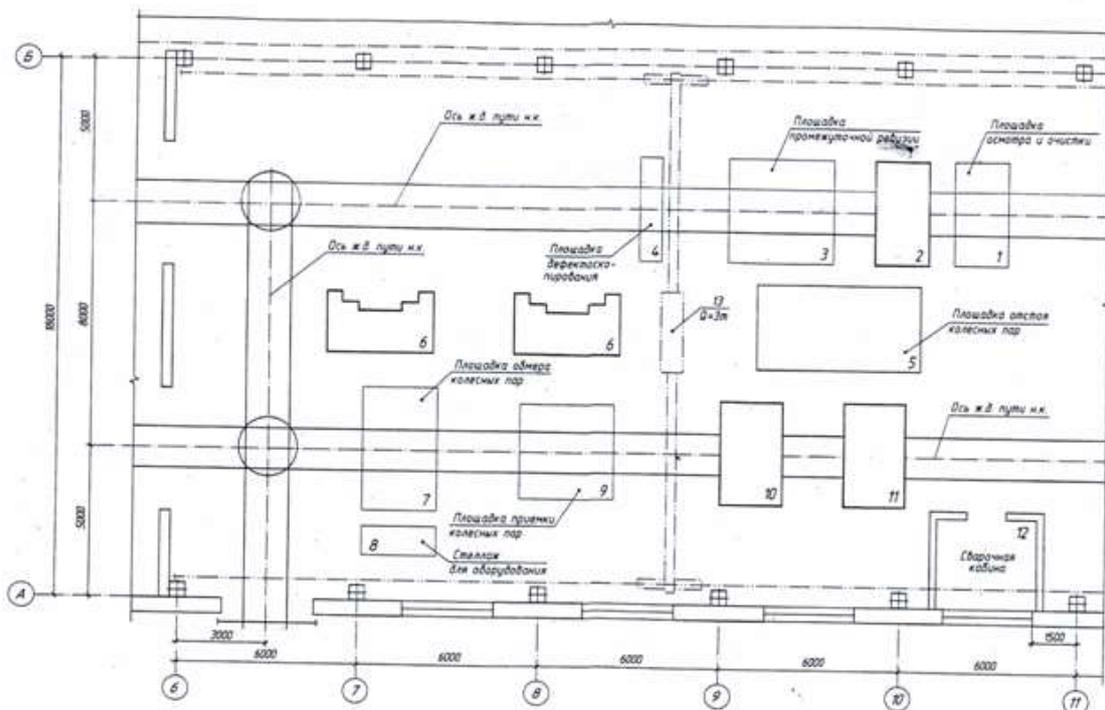
Примечание: 2 – моечная машина; 6 – токарный станок; 10 – машина для окраски; 11 – сушилка; 12 – кран-балка. Оборудование указать в спецификации.
