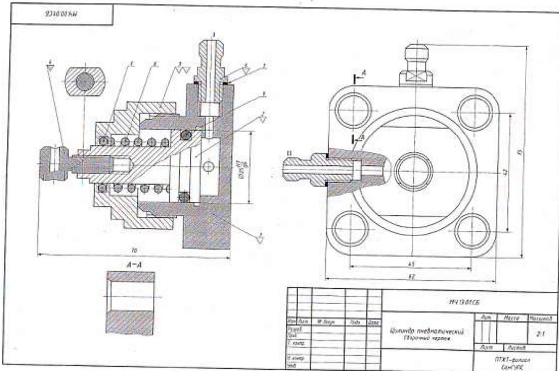
**Устройство и принцип действия пневматического цилиндра**
