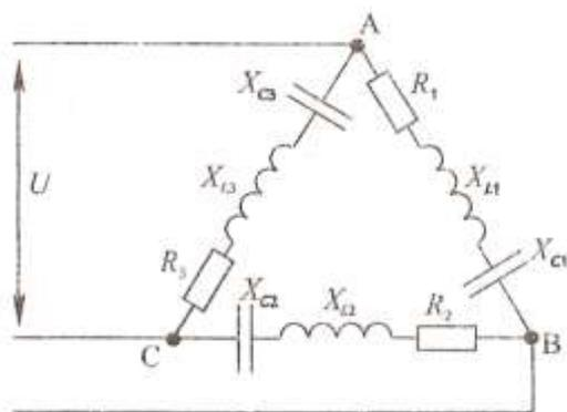
Исходные данные:  $U=120$  В,  $R_1=8$  Ом,  $X_{L1}=6$  Ом,  $X_{C2}=4$  Ом,  $R_2=3$  Ом,  $R_3=10$  Ом.
