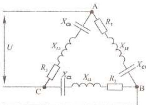
Исходные данные:  $U=87$  В,  $R_1=8$  Ом,  $X_{C1}=6$  Ом,  $R_2=10$  Ом,  $R_3=10$  Ом  $X_{L3}=10$  Ом.
