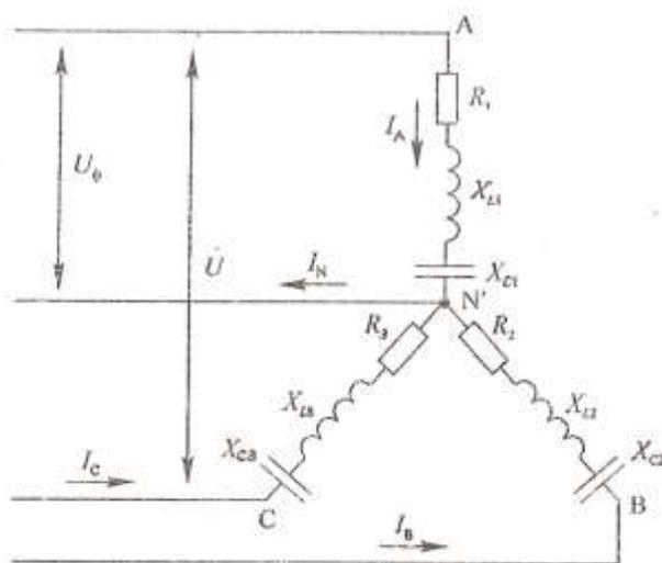
Исходные данные:  $U_{\text{л}}=80$  В,  $R_1=4$  Ом,  $X_{C1}=3$  Ом,  $R_2=3$  Ом,  $X_{L2}=4$  Ом,  $R_3=4$  Ом. Определить: линейные и фазные токи, построить векторную диаграмму. Примечание: вычертить схему согласно ГОСТу, при этом не чертить сопротивления, которые не заданы по условию задачи.
