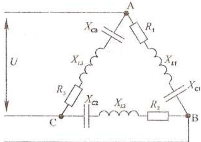
Исходные данные:  $U=80$  В,  $R_1=3$  Ом,  $X_{C1}=4$  Ом,  $R_2=6$  Ом,  $X_{L2}=8$  Ом,  $R_3=10$  Ом,  $X_{C3}=10$  Ом.
