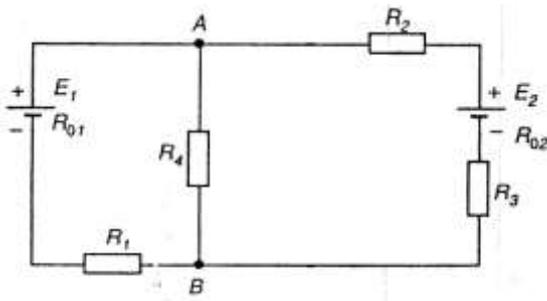
В сложной электрической цепи  $E_1=30$  В,  $E_2=40$  В,  $R_1=10$  Ом,  $R_2=2$  Ом,  $R_3=3$  Ом,  $R_4=12$  Ом,  $R_{01}=2$  Ом,  $R_{02}=1$  Ом.
