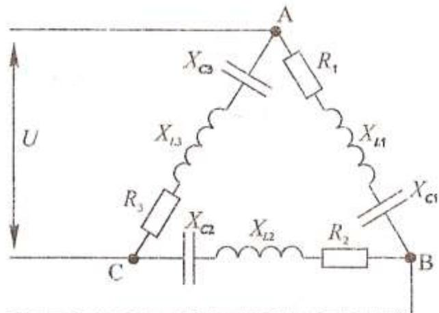
Исходные данные:  $U=120$  В,  $R_1=8$  Ом,  $X_{L1}=6$  Ом,  $X_{C2}=4$  Ом,  $R_2=3$  Ом,  $R_3=10$  Ом.
