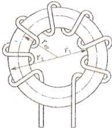
2. На схеме число витков 1500,  $I=50$  А, материал сердечника – литая сталь (Ст2).  $R_1=25$  см,  $R_2=45$  см. Определить абсолютную магнитную проницаемость, напряженность магнитного поля в точках внутреннего и внешнего радиусов, магнитную индукцию, магнитный поток.
