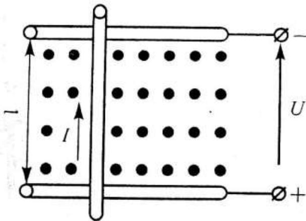
Проводник с током  $I=5$  А, сопротивлением  $r_0=0,2$  Ом и длиной  $l=1$  м находится в однородном магнитном поле с магнитной индукцией  $B=1,1$  Тл. Он присоединен к сети напряжением  $U=12$  В. В результате взаимодействия тока в проводнике и магнитного поля. Определить противо-ЭДС  $E_{пр}$ , наводимую в проводнике, скорость его движения  $V$ ,
