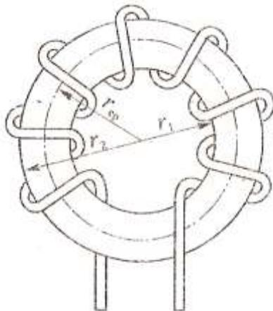
2. На схеме число витков 300,  $I=3,5$  А, материал сердечника – литая сталь (Ст2).  $R_1=5$  см,  $R_2=9$  см. Определить абсолютную магнитную проницаемость, напряженность магнитного поля в точках внутреннего и внешнего радиусов, магнитную индукцию, магнитный поток.
