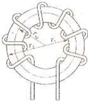
На схеме число витков 2650,  $I=35$  А, материал сердечника – литая сталь (Ст2).  $R_1=20$  см,  $R_2=40$  см. Определить абсолютную магнитную проницаемость, напряженность магнитного поля в точках внутреннего и внешнего радиусов, магнитную индукцию, магнитный поток.
