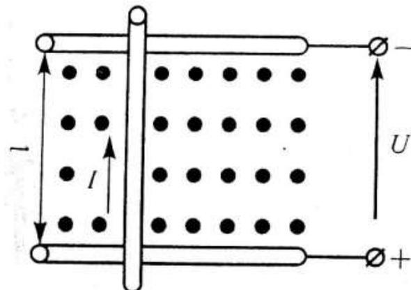
длиной  $l=1$  м. проводник с сопротивлением  $R=0,5$  Ом присоединен к источнику питания напряжением  $U=10$  В. Определить наводимую противо-ЭДС<sub>пр</sub>, ток в движущемся проводнике  $I_{дв}$ , электромагнитную силу  $F_{эм}$ , ток в остановленном проводнике  $I_{ост}$ . Составить уравнение баланса мощностей. На рисунке показать направления противо-ЭДС и электромагнитной силы.
