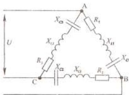
Исходные данные:  $U=150$  В,  $R_1=10$  Ом,  $X_{L1}=10$  Ом,  $X_{C2}=20$  Ом,  $R_2=10$  Ом,  $R_3=6$  Ом,  $X_{C3}=8$  Ом.
