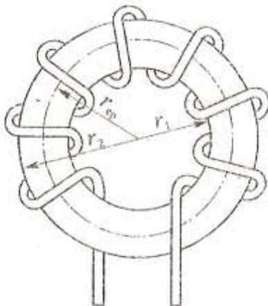
На схеме число витков 1000,  $I=20$  А, материал сердечника – литая сталь (Ст2).  $R_1=10$  см,  $R_2=30$  см. Определить абсолютную магнитную проницаемость, напряженность магнитного поля в точках внутреннего и внешнего радиусов, магнитную индукцию, магнитный поток.
