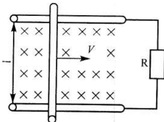
В однородном магнитном поле с магнитной индукцией  $B=1,5$  Тл перпендикулярно к направлению поля со скоростью  $v = 12$  м/с движется проводник длиной  $l=155$  см и сопротивлением  $r_0=5,8$  Ом. Проводник замкнут на
