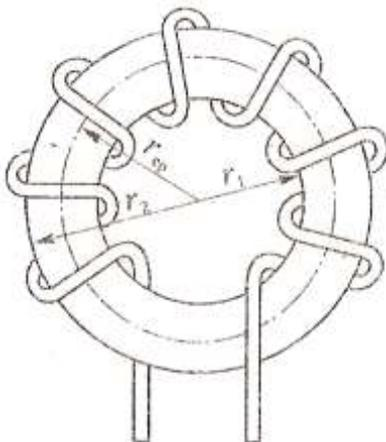
На схеме число витков 3000,  $I = 100$  А, материал сердечника – литая сталь (Ст2).  $R_1 = 25$  см,  $R_2 = 55$  см. Определить абсолютную магнитную проницаемость, напряженность магнитного поля в точках внутреннего и внешнего радиусов, магнитную индукцию, магнитный поток.
