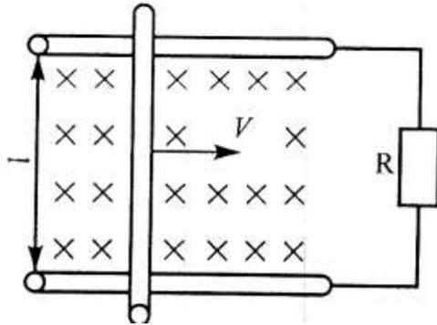
В однородном магнитном поле с магнитной индукцией  $B=1,8$  Тл перпендикулярно к направлению поля со скоростью  $V=8$  м/с движется проводник длиной  $l=25$  см и сопротивлением  $r_0=0,8$  Ом. Проводник замкнут на сопротивление  $R=1,2$
