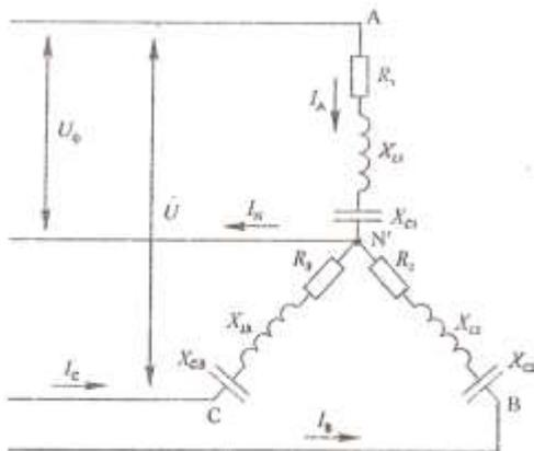
Исходные данные:  $U=80 \text{ В}$ ,  $R_1=4 \text{ Ом}$ ,  $X_{C1}=3 \text{ Ом}$ ,  $R_2=3 \text{ Ом}$ ,  $X_{L2}=4 \text{ Ом}$ ,  $R_3=4 \text{ Ом}$ .
