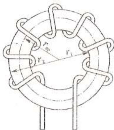
2. На схеме число витков 2000,  $I=23$  А, материал сердечника – литая сталь (Ст2).  $R_1=22$  см,  $R_2=56$  см. Определить абсолютную магнитную проницаемость, напряженность магнитного поля в точках внутреннего и внешнего радиусов, магнитную индукцию, магнитный поток.
