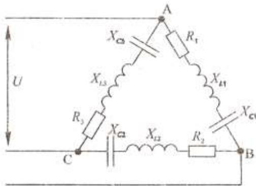
Исходные данные:  $U=173$  В,  $R_1=16$  Ом,  $X_{C1}=12$  Ом,  $R_2=14,1$  Ом,  $X_{L2}=14,1$  Ом,  $X_{C2}=20$  Ом,  $R_2=20$  Ом.
