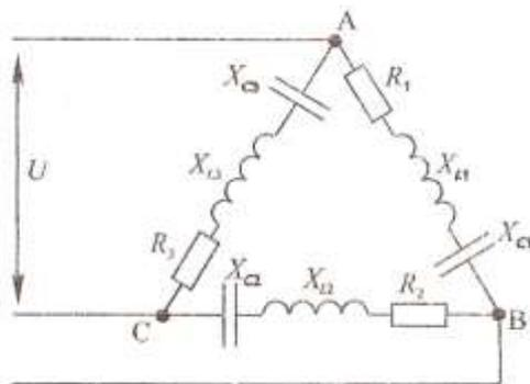
Исходные данные:  $U=80 \text{ В}$ ,  $R_1=3 \text{ Ом}$ ,  $X_{C1}=4 \text{ Ом}$ ,  $R_2=6 \text{ Ом}$ ,  $X_{L2}=8 \text{ Ом}$ ,  $R_3=10 \text{ Ом}$ ,  $X_{C3}=10 \text{ Ом}$ .
