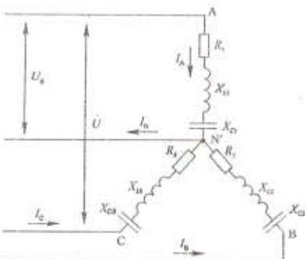
Исходные данные:  $U=220$  В,  $R_1=12$  Ом,  $X_{L1}=16$  Ом,  $R_2=20$  Ом,  $X_{C2}=20$  Ом,  $R_3=24$  Ом,  $X_{C3}=32$  Ом.
