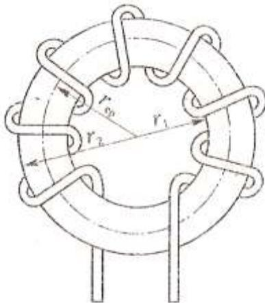
На схеме число витков 2500,  $I=50$  А, материал сердечника – литая сталь (Ст2).  $R_1=80$  см,  $R_2=90$  см. Определить абсолютную магнитную проницаемость, напряженность магнитного поля в точках внутреннего и внешнего радиусов, магнитную индукцию, магнитный поток.
