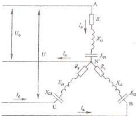
Исходные данные:  $U=380$  В,  $R_1=24$  Ом,  $X_{C1}=32$  Ом,  $R_2=12$  Ом,  $X_{L2}=16$  Ом,  $R_3=20$  Ом.
