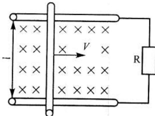
В однородном магнитном поле с магнитной индукцией  $B=1,8$  Тл перпендикулярно к направлению поля со скоростью  $v = 10$  м/с движется проводник длиной  $l=35$  и сопротивлением  $r_0=0,8$  Ом. Проводник замкнут на
