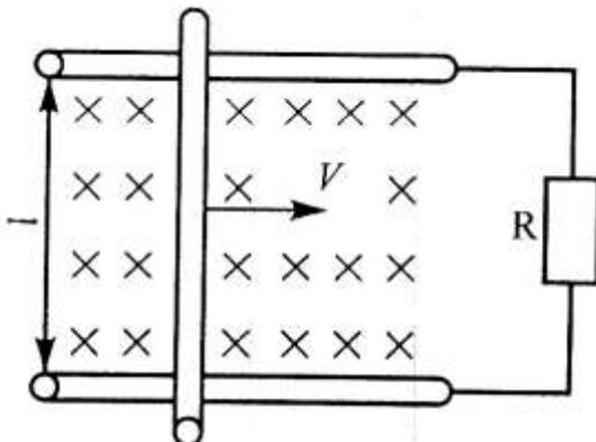
В однородном магнитном поле с магнитной индукцией  $B = 1$  Тл находится проводник длиной  $L=1$  м и током  $I=8$  А. проводник присоединен к сети напряжением  $U=10$ В. В результате взаимодействия тока в проводнике и магнитного поля он движется со
