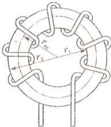
На схеме число витков 500,  $I=15$  А, материал сердечника – литая сталь (Ст2).  $R_1=15$  см,  $R_2=30$  см. Определить абсолютную магнитную проницаемость, напряженность магнитного поля в точках внутреннего и внешнего радиусов, магнитную индукцию, магнитный поток.
