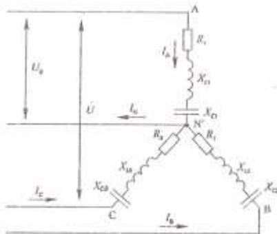
Исходные данные:  $U=127$  В,  $X_{L1}=8$  Ом,  $R_1=6$  Ом,  $R_1=16$  Ом,  $X_{C2}=12$  Ом,  $X_{L3}=10$  Ом,  $R_3=10$  Ом.
