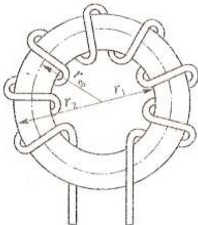
2. На схеме число витков  $3310$ ,  $I=48$  А, материал сердечника – литая сталь (Ст2).  $R_1=50$  см,  $R_2=80$  см. Определить абсолютную магнитную проницаемость, напряженность магнитного поля в точках внутреннего и внешнего радиусов, магнитную индукцию, магнитный поток.
