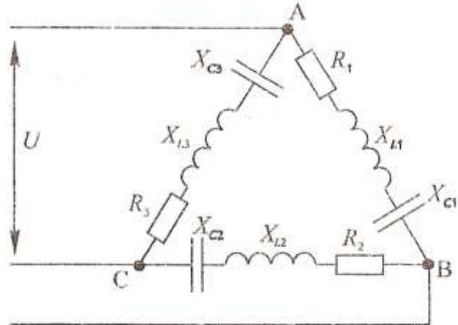
Исходные данные:  $U=220$  В,  $R_1=12$  Ом,  $X_{C1}=16$  Ом,  $R_2=10$  Ом,  $X_{L2}=10$  Ом,  $R_3=6$  Ом,  $X_{C3}=12$  Ом,  $X_{L3}=4$  Ом.
