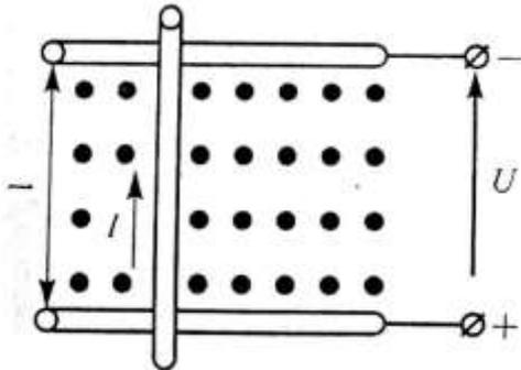
В однородном магнитном поле с магнитной индукцией  $B=1,2$  Тл перпендикулярно к направлению поля со скоростью  $V=8$  м/с движется проводник длиной  $l=1$  м. проводник с сопротивлением  $R=0,5$  Ом присоединен к источнику питания напряжением  $U=10$  В. Определить наводимую противоЭДС<sub>пр</sub>, ток в движущемся
