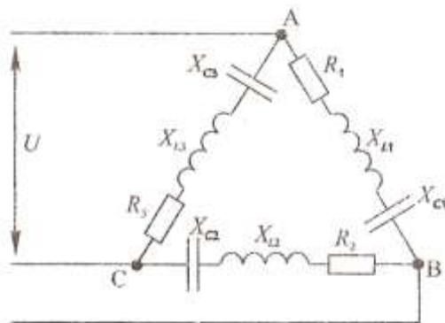
Исходные данные:  $U=90$  В,  $R_1=4$  Ом,  $X_{L1}=3$  Ом,  $X_{C2}=8$  Ом,  $R_2=6$  Ом,  $R_3=12$  Ом,  $X_{L3}=20$  Ом,  $X_{C3}=4$  Ом.
