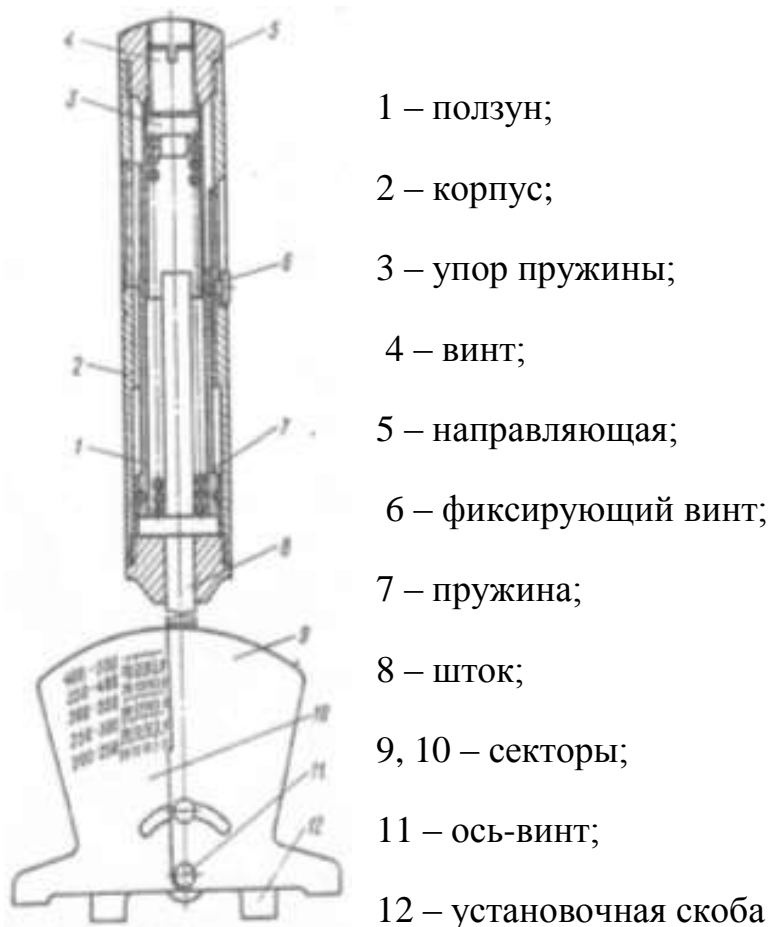
Рисунок – Устройство КИ-8920 для проверки натяжения ремней вентилятора, генератора и компрессора
