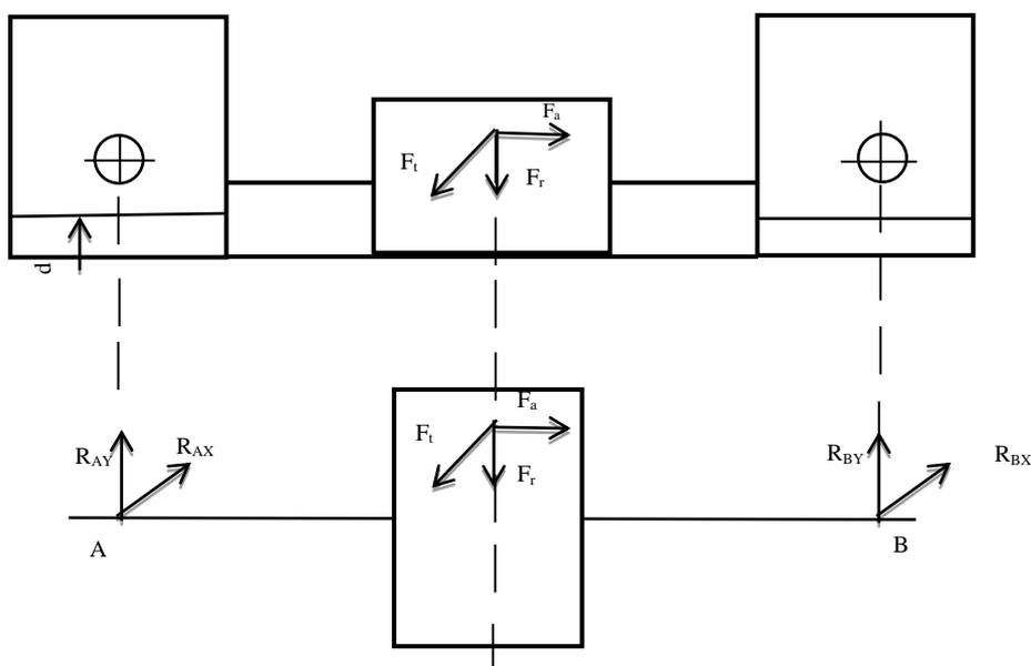
Рис.1 Схема вала.
