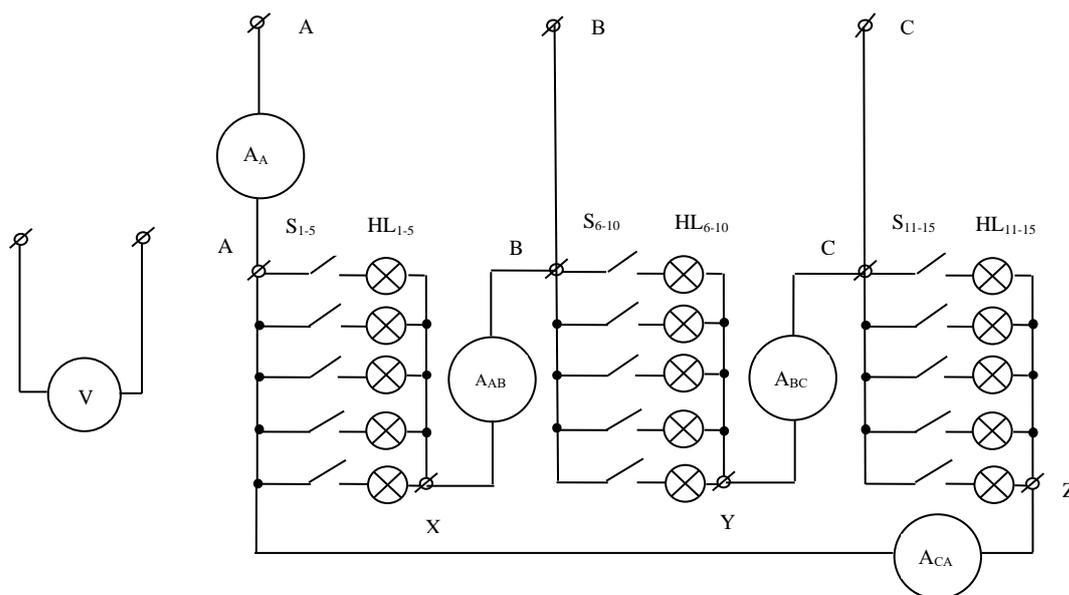
2. После проверки схемы преподавателем замкнуть тумблеры «ABC», установить равномерную нагрузку фаз (по 5 лампочек в фазе) и снять показания приборов, а результаты занести в таблицу (первый опыт).
