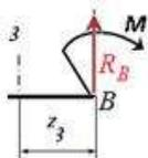
Поперечная сила  $Q_3$  равна сумме всех внешних сил, действующих на участке
