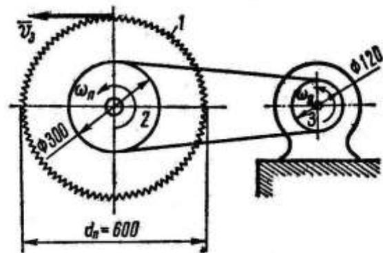
$$v_3 = \rho \cdot \omega_{\text{п}} \text{ или } v_3 = d_{\text{п}} / 2 \cdot \omega_{\text{п}}$$
