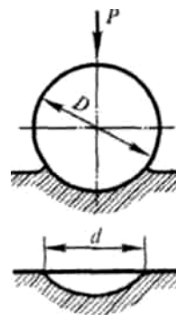
Лунка при определении твердости по
