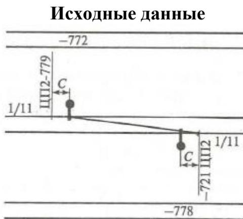
Рис 1. Схемы фиксации одиночных воздушных стрелок
