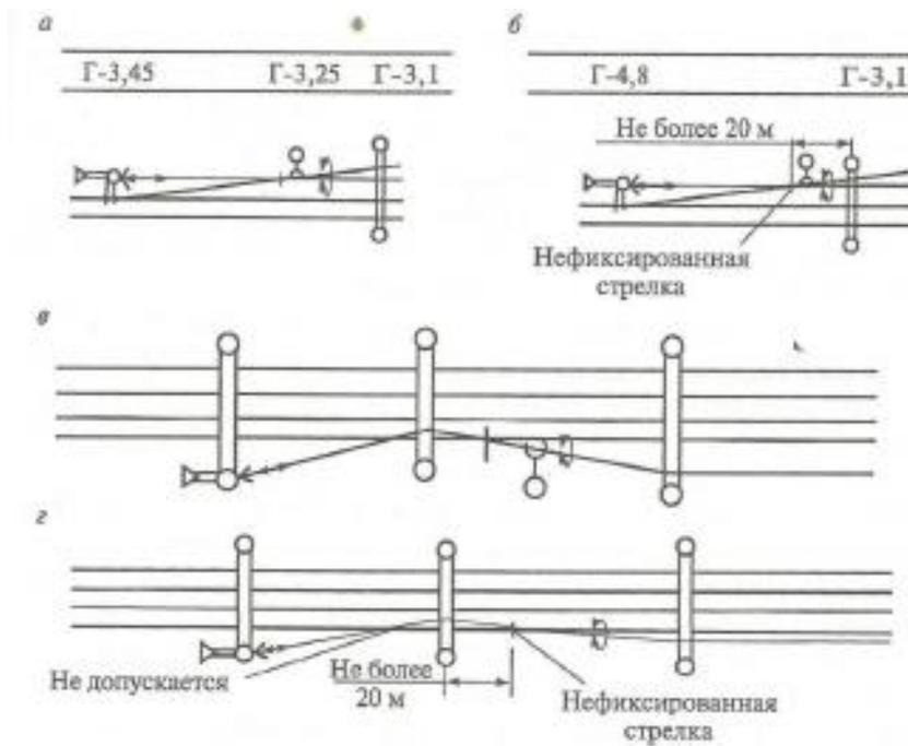
Рис 2. Фиксация воздушных стрелок на плане контактной сети станции (а, б).
