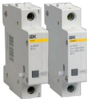
Расцепитель независимый РН-47 служит для дистанционного отключения автоматических выключателей. Устройство имеет кнопку «ВОЗВРАТ», которая выступает из лицевой панели при срабатывании расцепителей, что позволяет определить причину отключения автомата – падение напряжения, дистанционное отключение или перегрузка (сверхток)
