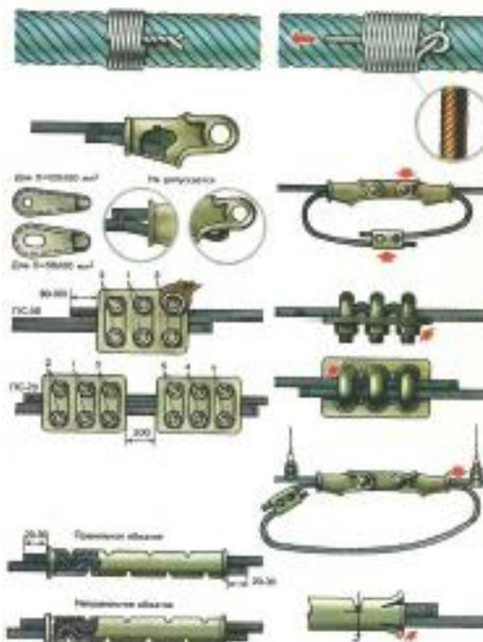
Рис 1.2. Виды стыкования проводов воздушных линий
