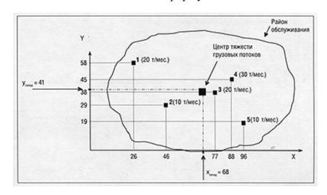
Рис. 1. Определение места расположения склада методом поиска центра тяжести грузовых потоков
